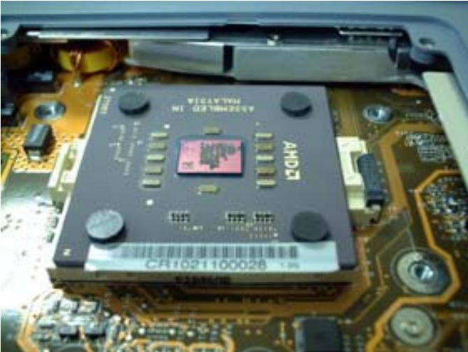
CPUのピンに気を付けて、しっかりとソケットにCPUを図のように取り付けて下さい。
