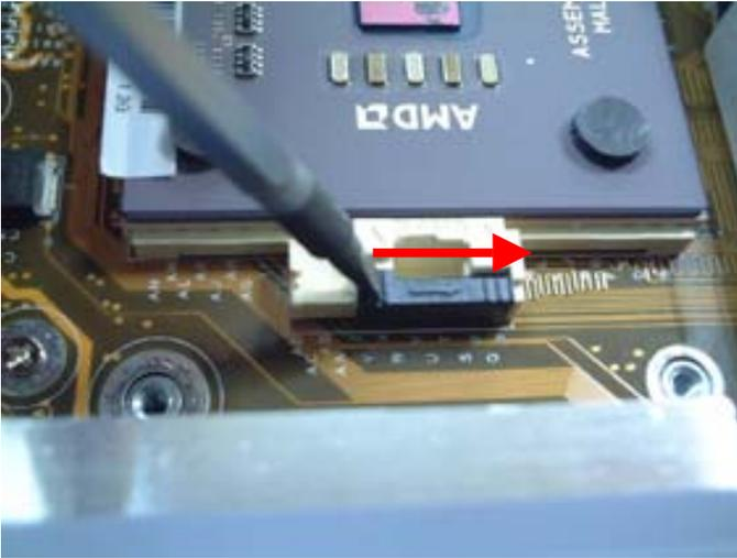
Step6 のように CPU およびソケット上部のスライドが完了後、上記図のようにロックしてください。
