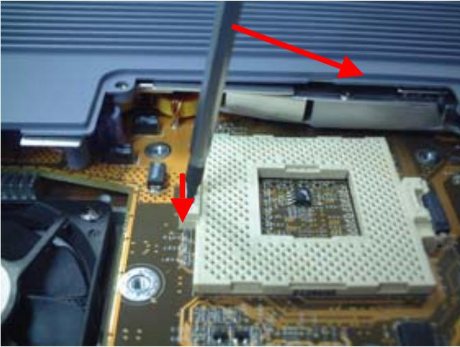
先が平らなドライバーの場所の場所に差し込み、矢印の方向に力を加え、ソケット上部を矢印方向にスライドさせてください。
