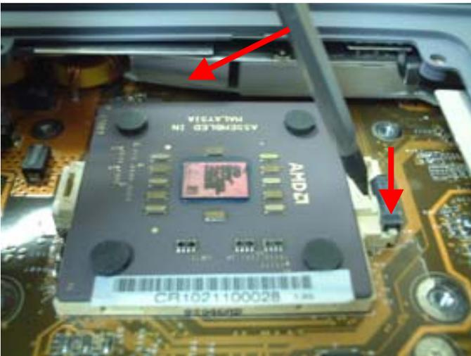
CPUは取り付けただけでは使用できません。図のように先が平らなドライバーを使用して、矢印の方向に力を加え、CPUおよびソケット上部をスライドさせ、CPUを固定してください。
