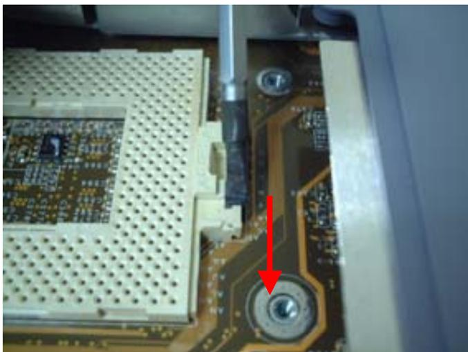
上記図のようにロックをずらし、CPU ソケット上部がスライドできるようにします。
