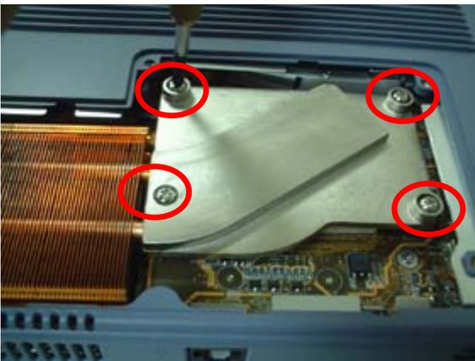
上記図のようにヒートシンクを取り付け、ねじ止めをすることで、CPU の取り付けは完了します。
